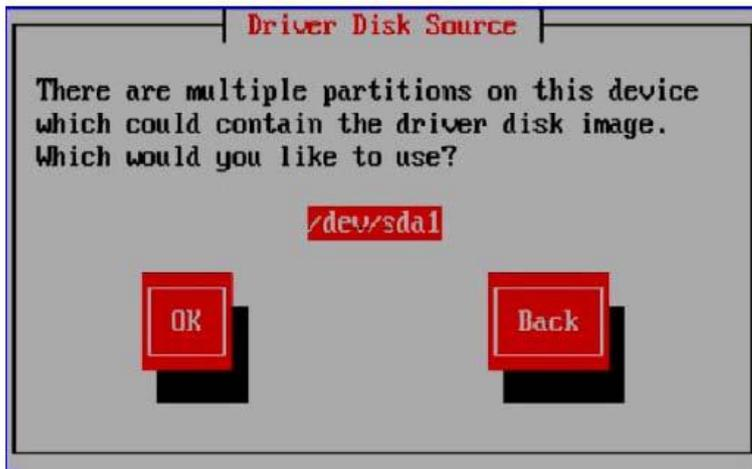
7. 如果 U 盘中有多个文件, 会弹出驱动选择界面, 请选择正确的驱动程序文件, 选择【OK】, 按【回车】键, 系统开始加载驱动程序, 加载完成后, 弹出以下窗口, 提示是否还需要添加其他程序。
