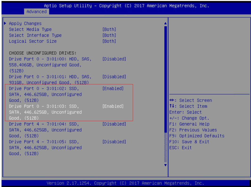
7. 在下面界面添加成员盘，再增加一个 span。备注：此处选中 2 块硬盘，做一个 span。
