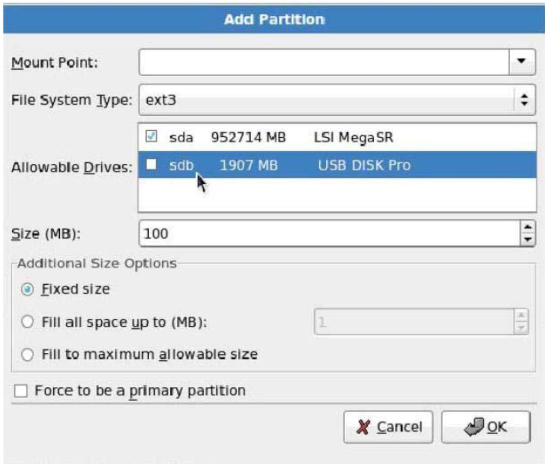
9. 在 Red Hat Linux 6.x (x 代表 1、2、3、4、5、6) , 在创建分区时会自动检测到 U 盘, 请将 U 盘前面方框中的【√】去掉, 避免在 U 盘上创建磁盘分区。
