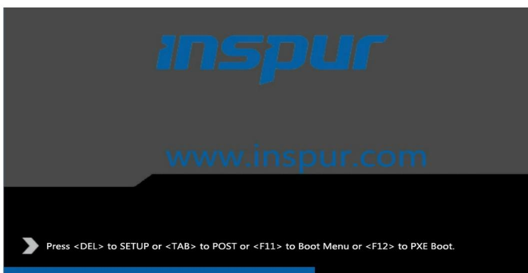
3. 开机后，进入 BIOS 设置界面，确认 Storage 为 UEFI，路径：Advanced→GSM Configuration→Storage。
