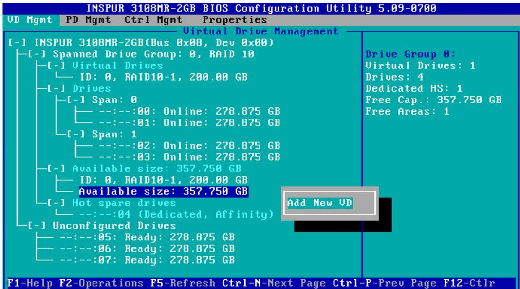
16. 同一组硬盘只能创建同类型的 RAID 级别，再按照上述的步骤设置【Size】，【Name】以及【Advanced】内容，最后选择【OK】，如下图。
