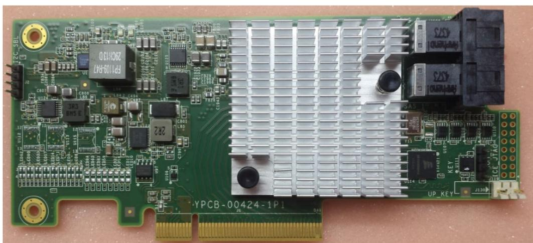
Inspur SAS3008iMR RAID 卡采用 Broadcom 公司的 SAS3008 IO 硬盘控制器。采用 PCIe3.0 x8 接口，提供强大的 I/O 存储引擎，可透明执行所有的数据检验和恢复任务。
