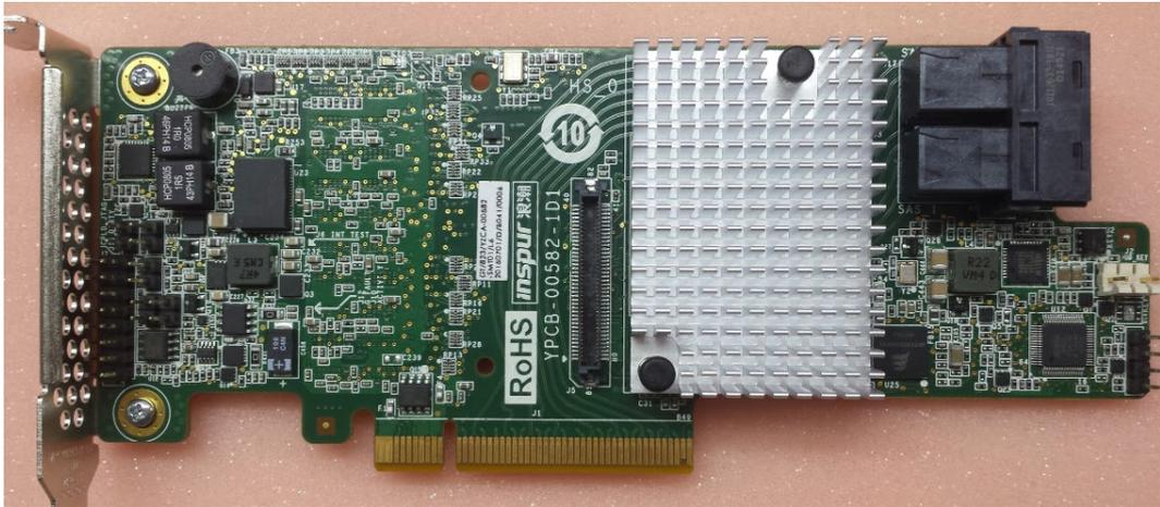
Inspur SAS3108 RAID 卡采用 Broadcom 公司的新一代 SAS3108 硬盘控制器。SAS3108 是基于 MegaRAID 架构的 8 端口 12Gbit/s SAS 控制器，并采用 PCIe 3.0 x8 接口，提供强大的 I/O 存储引擎，可透明执行所有的数据保护、数据检验和恢复任务。
