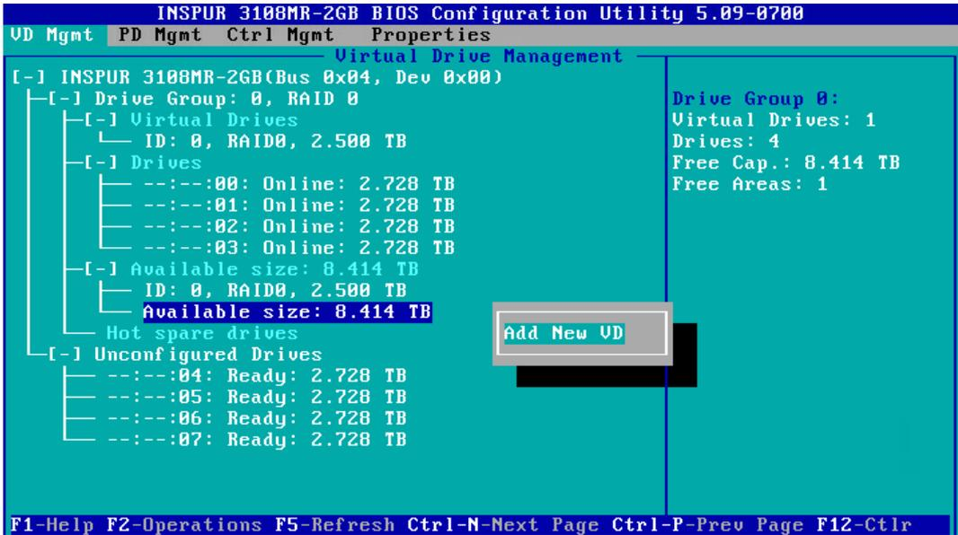
14. 同一组硬盘只能创建同类型的 RAID 级别, 再按照上述的步骤设置【Size】, 【Name】以及【Advanced】内容, 最后选择【OK】, 如下图。
