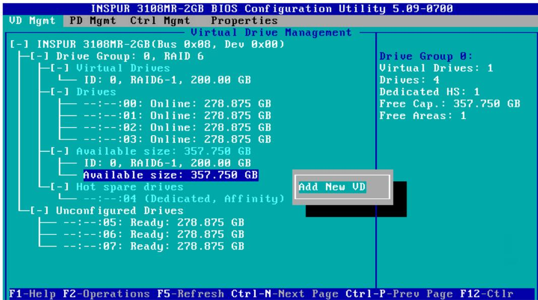
15. 同一组硬盘只能创建同类型的 RAID 级别，再按照上述的步骤设置【Size】，【Name】以及【Advanced】内容，最后选择【OK】，如下图。
