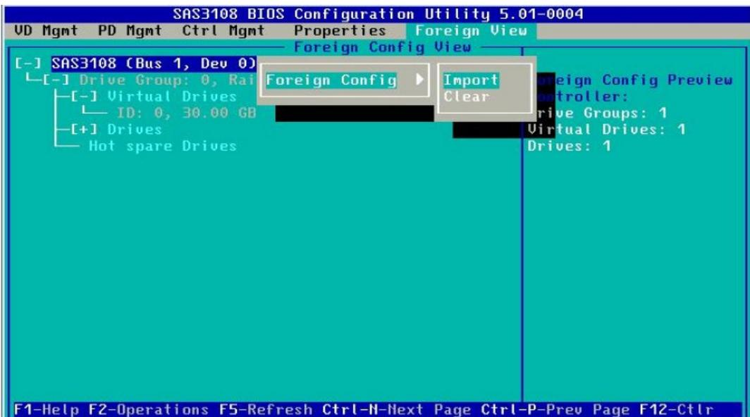
4. 选择【Import】导入外部配置，或选择【Clear】清楚外部配置，并按【Enter】确认，导入完成后，可在【VD Mgmt】菜单中查看配置结果。
