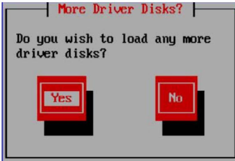
8. 如果还有其他驱动需要添加请选择【Yes】, 按上面的方法添加其他驱动程序, 如果没有其他驱动程序需要添加请选择【No】, 然后根据提示完成 Red Hat Linux 操作系统的安装。图中的【sdb 1907MB USB DISK Pro】指的就是 U 盘, 在创建硬盘分区时, 请将其前面方框中的【√】去掉。
