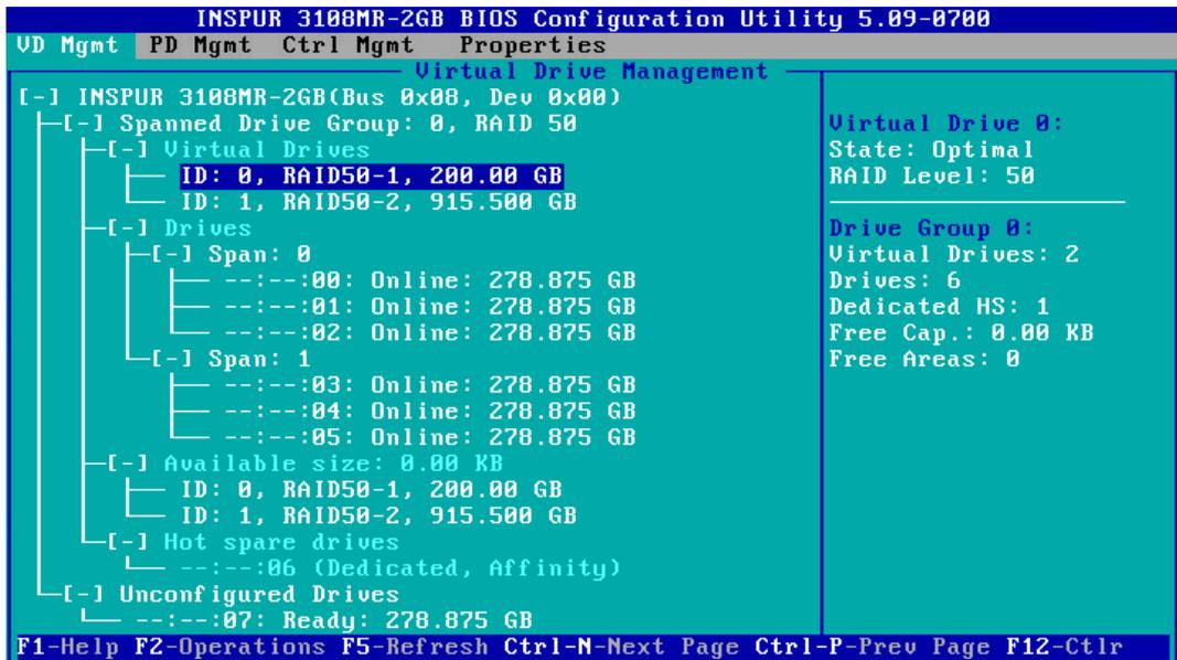
19. 创建完成后，按 ESC 退出，系统弹出确认退出配置对话框，如下图。
